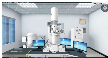
图 1 TEM 三维虚拟造型示意图
